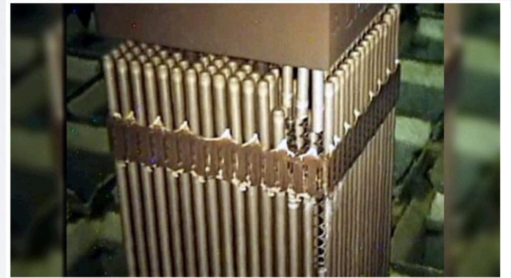
**Skade på stavsystemer er vanlig. Brenselpellets lekker da til det primære kjølevannet. Innkapslingen av pellets har til formål å hindre lekkasje av radioaktivitet. Den er tynnvegget for å begrense nøytrontap og kan ødelegges ved overoppheting dvs nedsmelting.**
